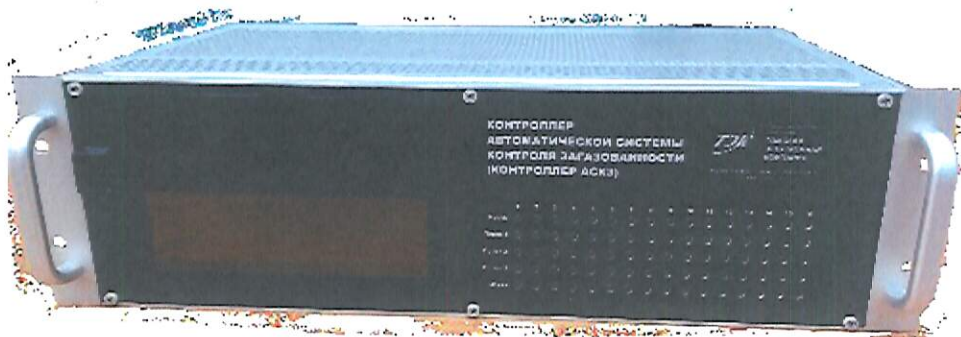
Рисунок 2 – Общий вид контроллеров АСКЗ (лицевая панель)
